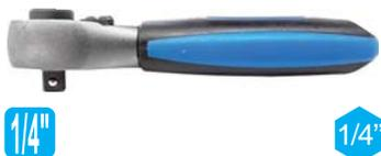
In acciaio CROMO-VANADIO. Leva a cricco COMBINATA con attacco esagonale femmina 1/4" per bits da una parte e attacco quadro maschio 1/4" per bussole dell'altra. Con levetta per movimento D+S.
